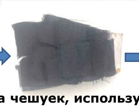
Размещение комплекса чешуек на крыло Bionicbird
